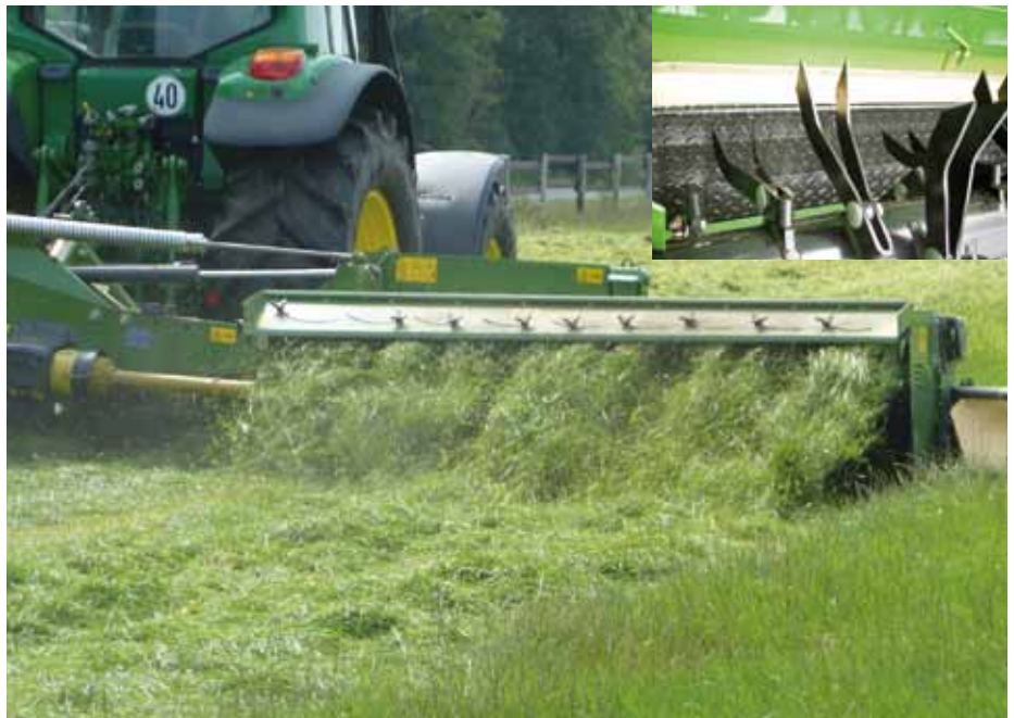
Nova bočna kosilnica EasyCut z gnetilnikom, z jeklenimi prsti, ki se vbadajo v krmo, pri naletu na oviro pa premaknejo nazaj (manjša slika).
