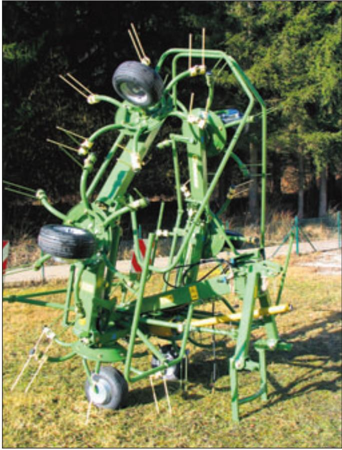
Obremenitve nosilnega okvirja prevzemajo oglati profili velike nosilnosti. Pozitivne lastnosti obračalnika se začnejo že pri obračalnih prstih. Gre za prste premera 9,5 mm in petimi ovoji, ki zagotavljajo stroju največjo možno elastičnost. Pri tem so notranji prsti obračalnika krajši kot zunanjji, zato se ne dotikajo tal. S tem ostaja krma kakovostna, saj se ne umaže z zemljoi.
